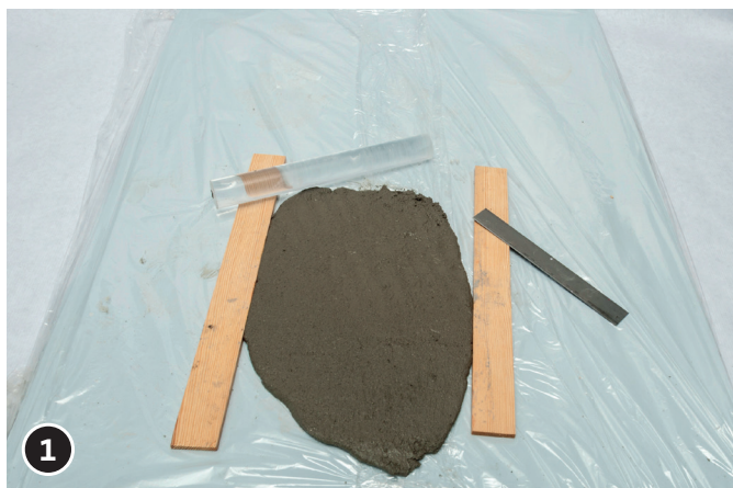
1 Preparar la mezcla de hormigón como se indica en las instrucciones del producto. Extender una plancha de hormigón de 5 mm de grosor.
