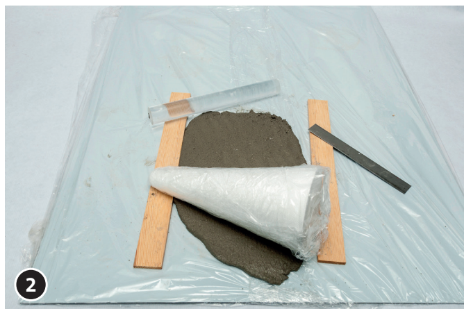
2 Envolver la bóla de pórex con papel film. Colocar la plancha de hormigón sobre la bola.
