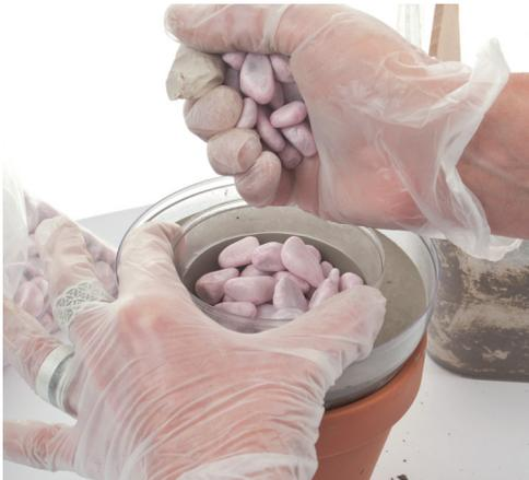
7. Colocar piedras en el interior de la bola de 18 cm para que el hormigón no se levante.
